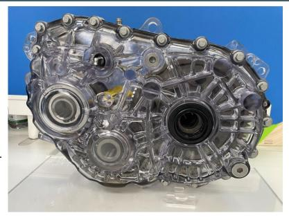
为了观察减速箱内齿轮传动、啮合及各零部件的润滑情况,验证减速箱飞溅润滑效果和润滑油的空间分布,壳体采用PC塑料雕刻成型,其良好的机械性能及高度透明性,为减速箱的润滑试验,提供很好的可视性,如图为透明壳体减速箱总成。
