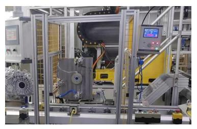
为提高客户满意度,提升过程稳定性,解决油封翻边过程质量问题。由蔚邦质量部牵头,生产部、设备部合作,计划通过增加反向气密设备,开展反向气密检测工作,对油封翻遍过程问题进行正向改善。目前设备正在调试安装中。同时,推动供应商进行来料质量提升,以降低并减少油封翻遍质量问题,为全面提升蔚邦产品质量,塑造品牌形象提供了良好的质量支撑。
