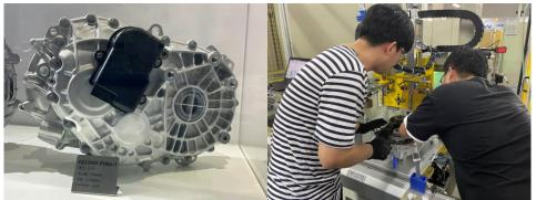
6月, 蔚邦首台OTS 样件 Ma+产品顺利装配完成。 装配过程中, 各部门共同 协作, 积极配合, 装配工 作得以顺利完成。Ma+样 件加装驻车机构, 是蔚邦 开发的首台具有驻车功能 的变速箱。Ma+产品的顺 利装配, 为后续进一步的 新品开发打下夯实的基础。
